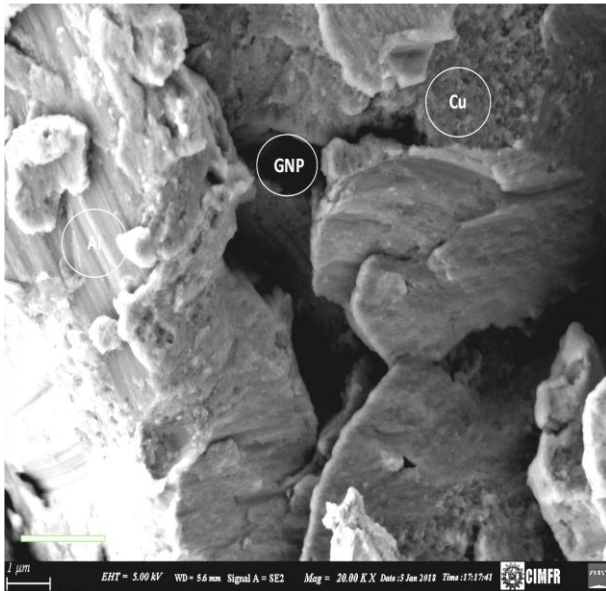
Fig. 4. Layered Al/GNP/Cu powder.
